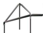
Piquets triangulés (constituée d'un ensemble de 3 piquets)
